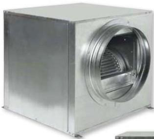
Cajas de ventilación, de bajo nivel sonoro, fabricadas en chapa de acero galvanizado, aislamiento acústico ignífugo (M1) de espuma de melamina, ventilador centrífugo de doble aspiración montado sobre soportes antivibratorios, rodete de álabes hacia adelante equilibrado dinámicamente y motor IP44, Clase F (modelo CVT-380/380-N-2200W, IP54, Clase F), monofásico o trifásico, según versión.
